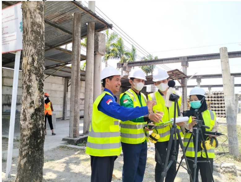
Gambar 1. Proses Pengambilan Data dengan Pengukuran Kebisingan di Industri B
